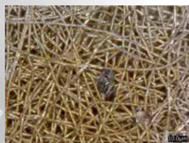
4. ábra: Oszlop bemeneti fritt mikroszkópos felvétele, nem szűrt \text{NH}_4\text{OAc} -puffer használata után (700x-os nagyítás).
